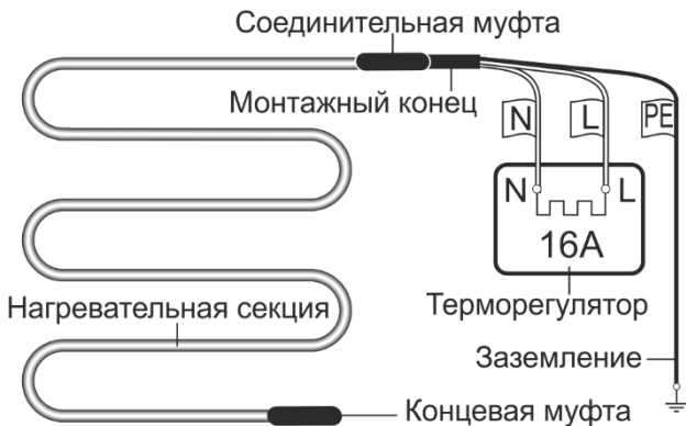
Рисунок 6 – Подключение теплого пола к терморегулятору.
