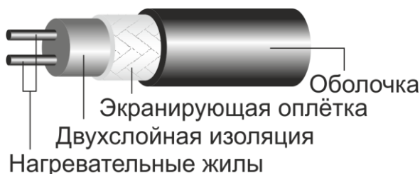
Рисунок 3 – Устройство нагревательного провода.
