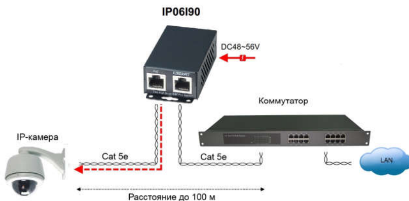
Рис.3 Схема подключения инжектора IP06190
