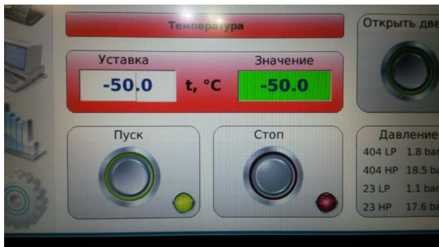
Фото панели управления камеры тепла-холода (на этапе испытаний при экстремально низких температурах):
