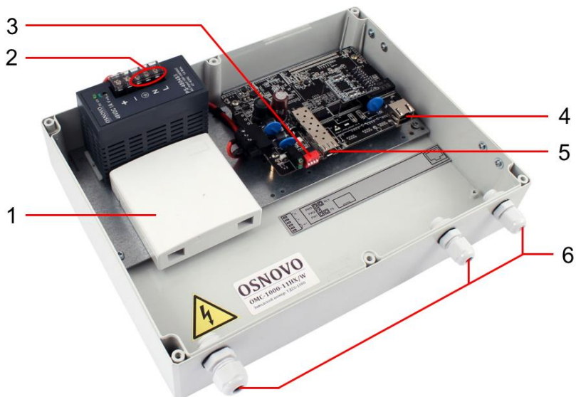
Рис.4 Подключение медиаконвертера OMC-1000-11HX/W
