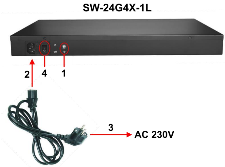
Рис. 6 Подключение коммутатора к сети AC 230V
