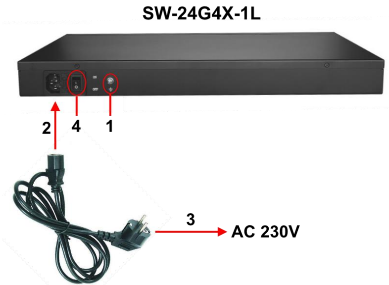
Рис. 6 Подключение коммутатора к сети AC 230V
