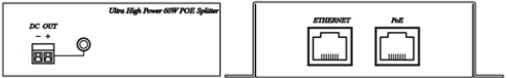
Рис.2 Разъемы и индикаторы IP06S60-24
