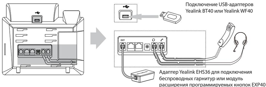
**Примечание:** для подключения USB-адаптеров, Yelink EHS36 и модулей расширения программируемых кнопок EXP40 воспользуйтесь инструкцией на сайте или инструкцией, поставляемой в комплекте к подключаемому устройству.
