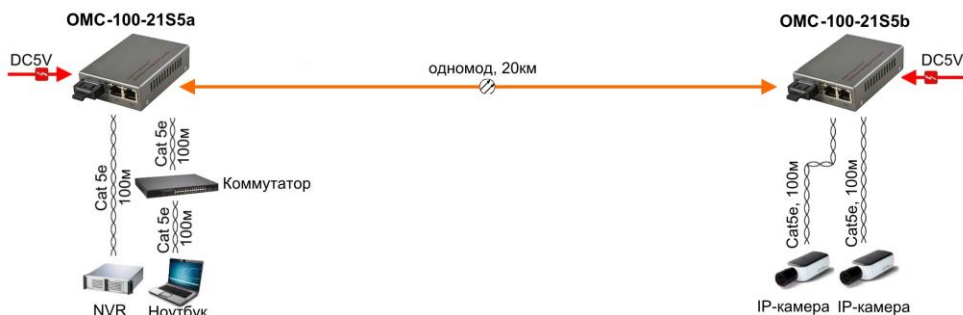
Рис. 7 Схема подключения медиаконвертеров OMC-100-21S5a (OMC-100-21S5b)
