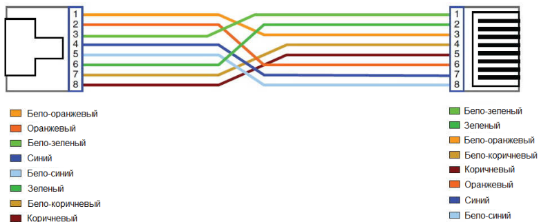
Рис. 9 Обжимка кабеля по типу TIA/EIA-568-B.
