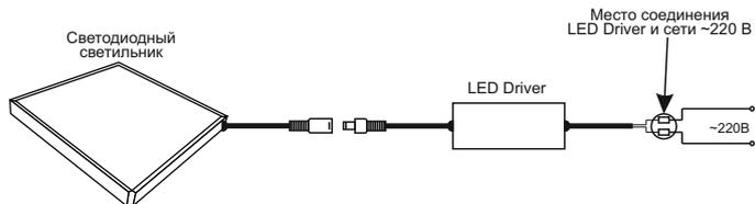
Рисунок 2 — Схема подключения изделия
