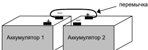
Рисунок 2 – схема последовательного соединения двух аккумуляторов
