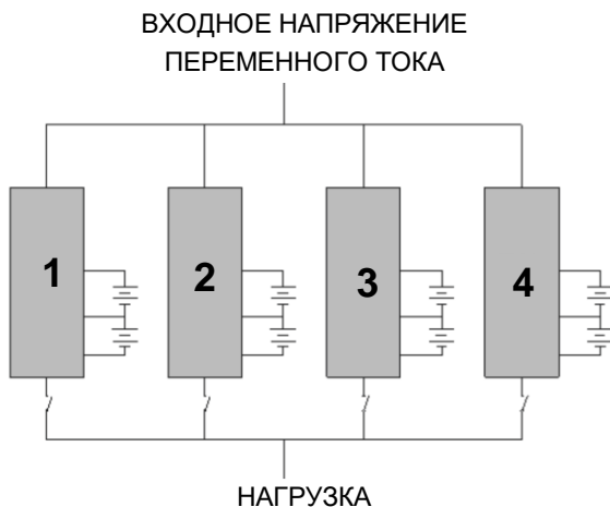
Рисунок 24 — Схема подключения изделий в систему параллельного резервирования.
