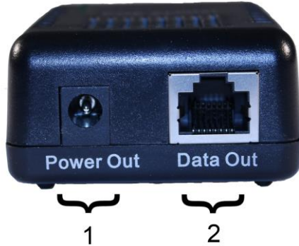
Рис. 2. Сплиттер PoE Splitter/1, вид спереди
