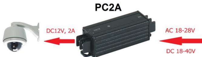
Рис.5 Типовая схема подключения преобразователя PC2A
