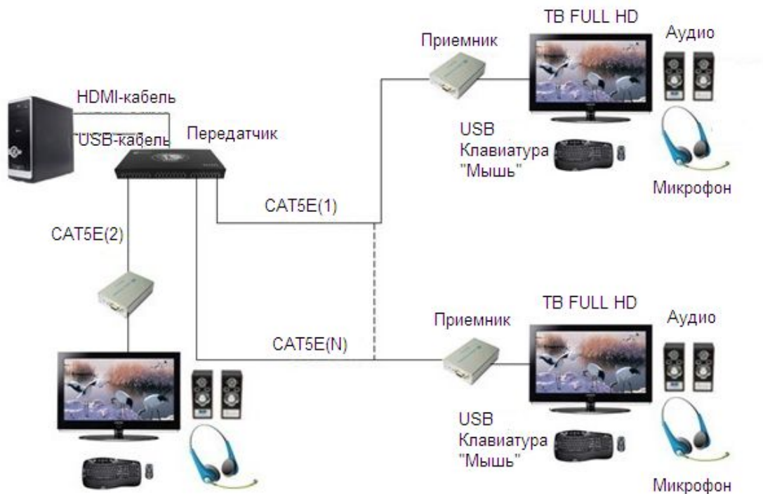
Рис.3 Схема подключения передатчика TA-Hi07 и приемника RA-Hi/1
