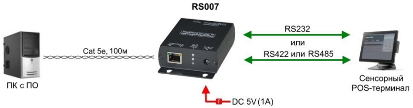
Рис.4 Типовая схема подключения преобразователя RS007
